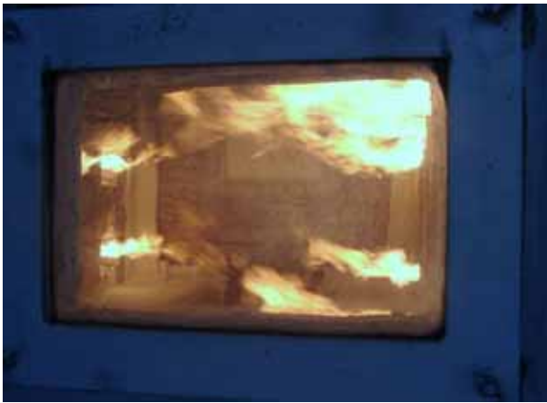
耐火試験装置炉内 加熱開始直後
